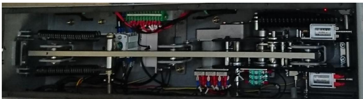
Рис. 6. Пружинно-механический привод реклоузера СЕТ-RV-10.
